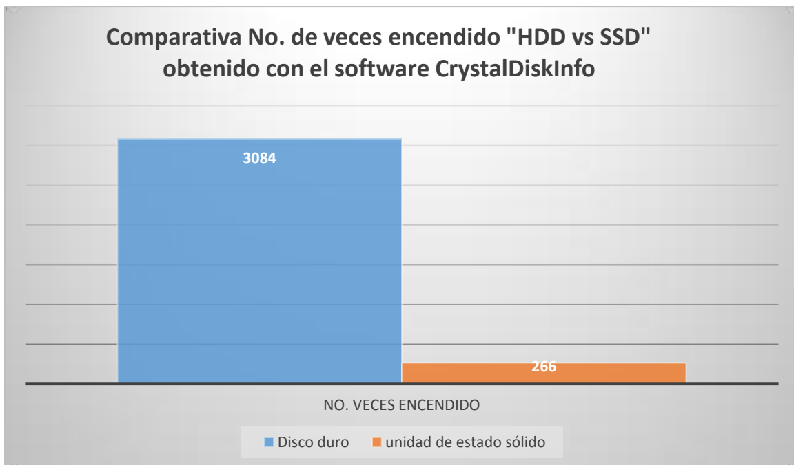
Gráfica 1 Comparativa No. de veces que se encendió el HDD y SSD obtenido con el software CrystalDiskInfo.
